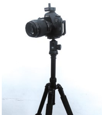
Afb. 1 Canon 6D DSLR met Canon 100 mm F2.8 EF macro USM, op een statief van Sirui KTV-204 met L-bracket.
